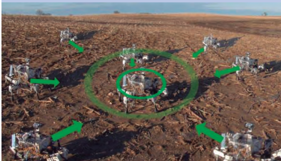
Un experto norteamericano creó prototipos de robot microplantadores de semillas, los cuales van censando el suelo en el que trabajan, se comunican con otras máquinas y trabajan de manera coordinada respondiendo a una determinada prescripción técnica que ellos mismos van generando en tiempo real.
