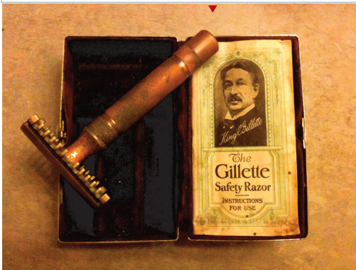
La máquina de afeitar de Gillette estaba formado por un mango con un soporte en T sobre en el que se inserta una hoja ligeramente curvada con filo en ambos lados.
