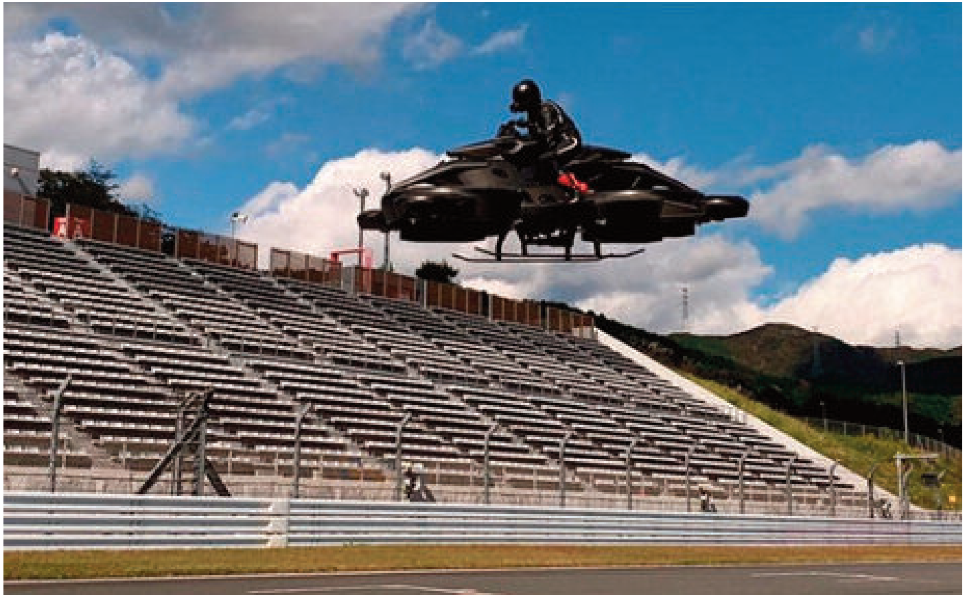
Las dos grandes hélices son las que dan sustento en el aire, y las cuatro pequeñas, le dan dirección.
