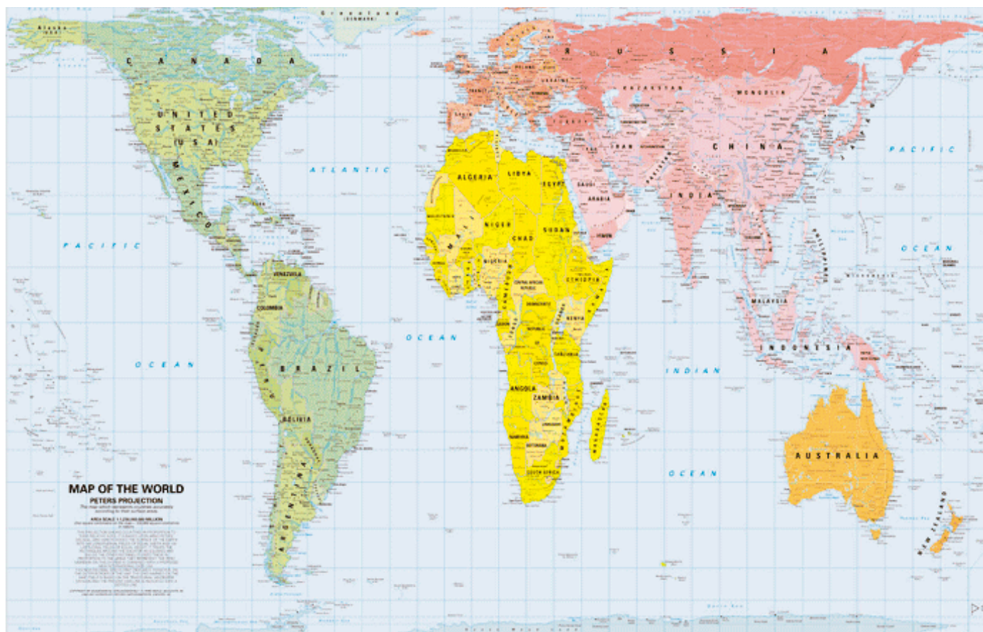
El mapa de Peters (también conocido como la proyección de Gall-Peters) es especialmente conocido por lograr que cada cuadrícula represente un área igual a las demás. Fuente: Wikipedia.
