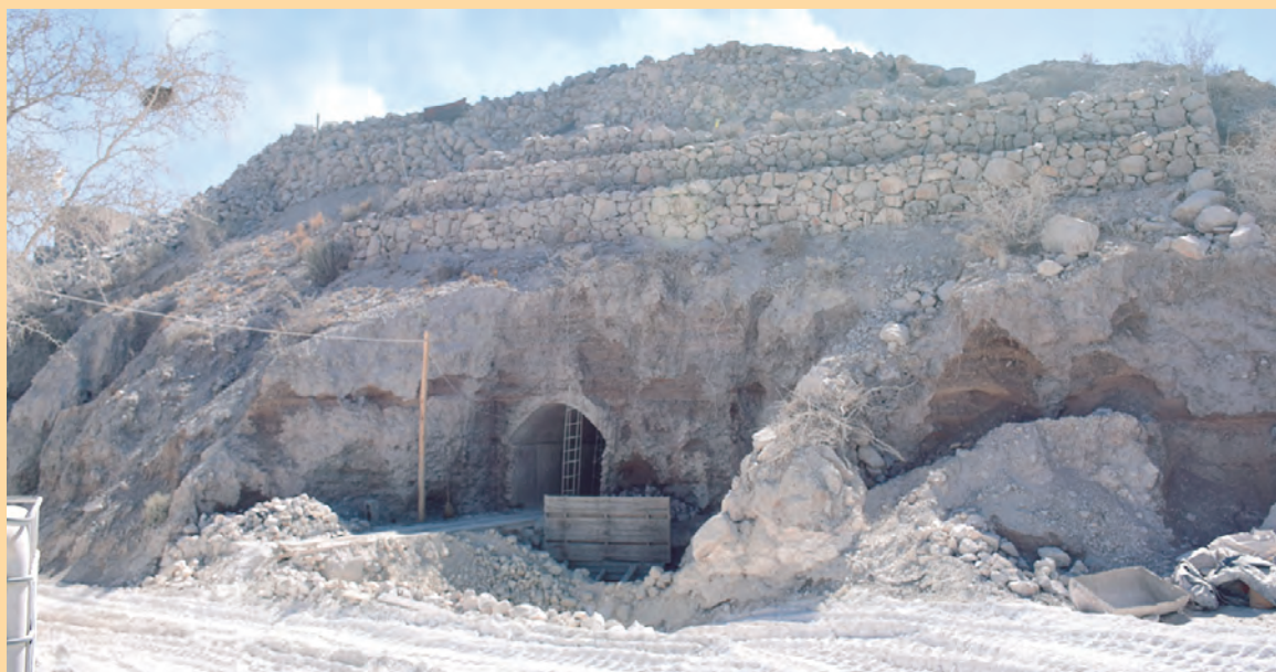
Así se ve la boca de salida de un horno calero criollo, de donde sale la cal terminada.
