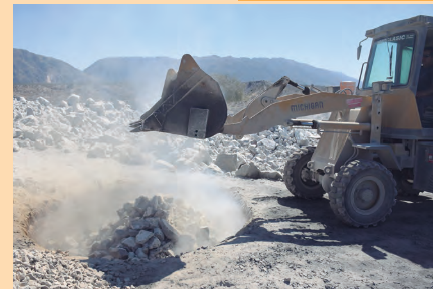
Eduardo Ruarte incorpora piedra caliza en la parte superior del horno con la retroexcavadora.
